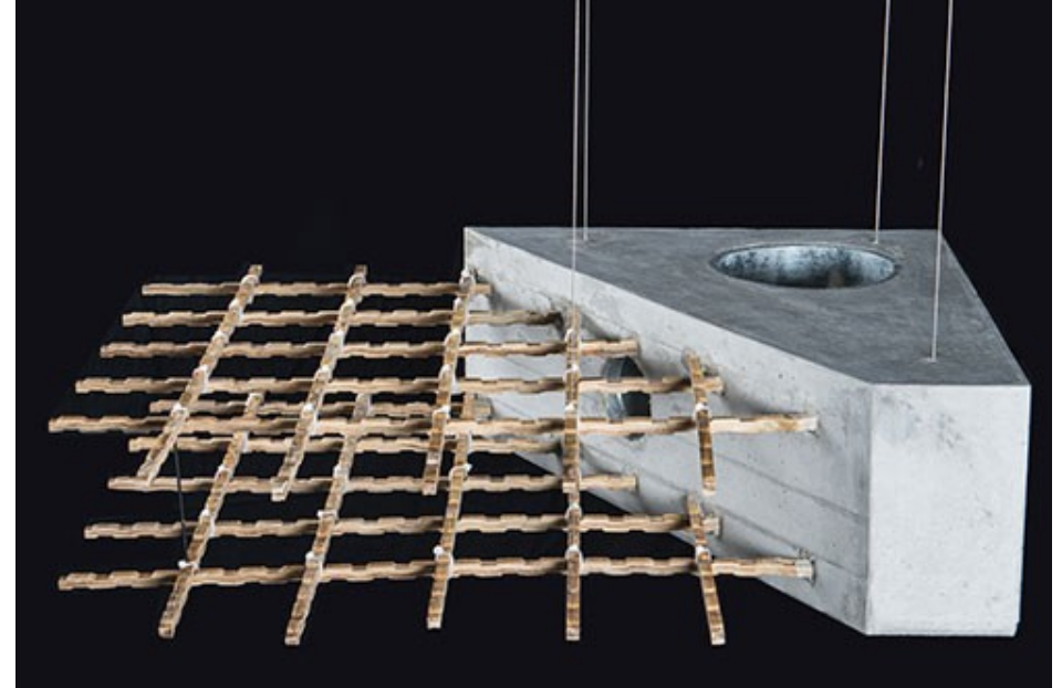
RETE DI BAMBU' PER INTEGRAZIONE IN CALCESTRUZZO ARMATO
